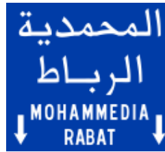
Figure 127 : Exemple de panneau de signalisation avancée
