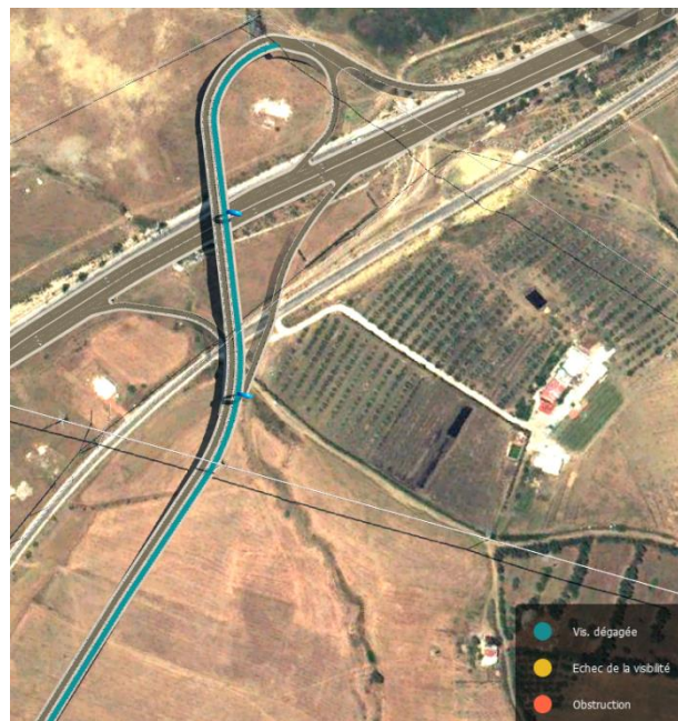
Figure 71 : résultats de l'analyse de visibilité de la bretelle 1 après modification
