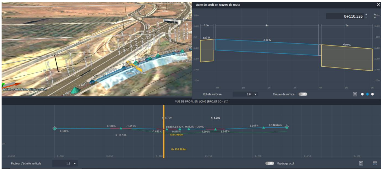
Figure 68 : dynamisme entre profil en long, axe en plan et profil en travers
