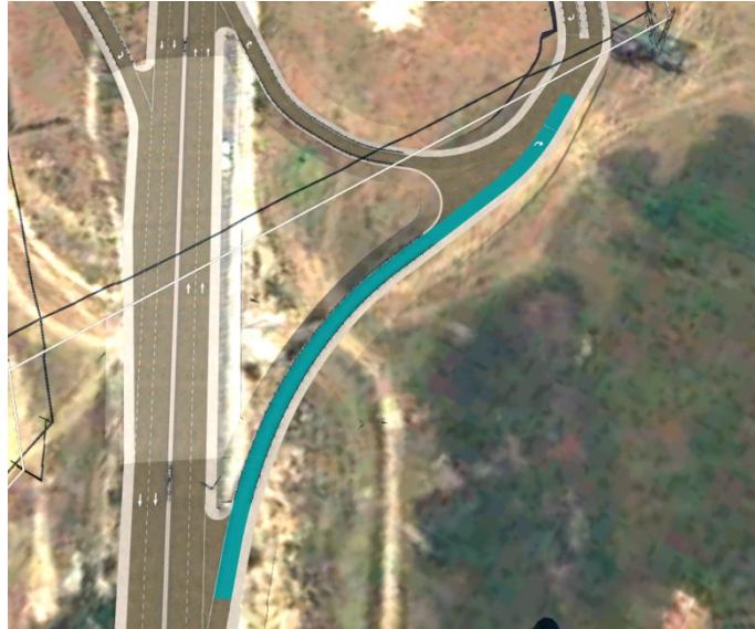
Figure 74 : analyse de la visibilité de la bretelle 4
