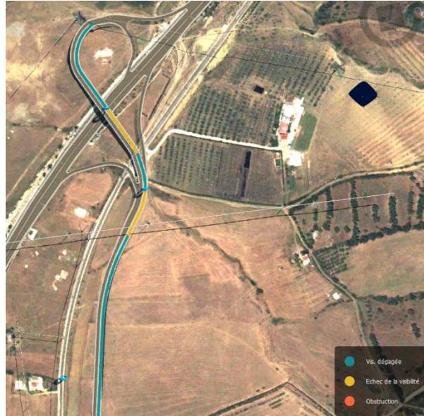
Figure 70 : résultats de l'analyse de visibilité de la bretelle 1
