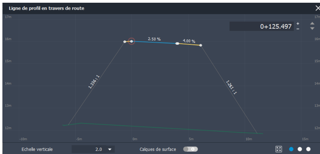
Figure 67 : profil en travers d'une bretelle
