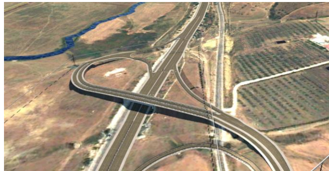
Figure 64 : tracé en plan de la première variante de l'échangeur
