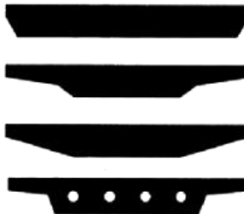
Figure 37 : Sections transversales des ponts dalles
